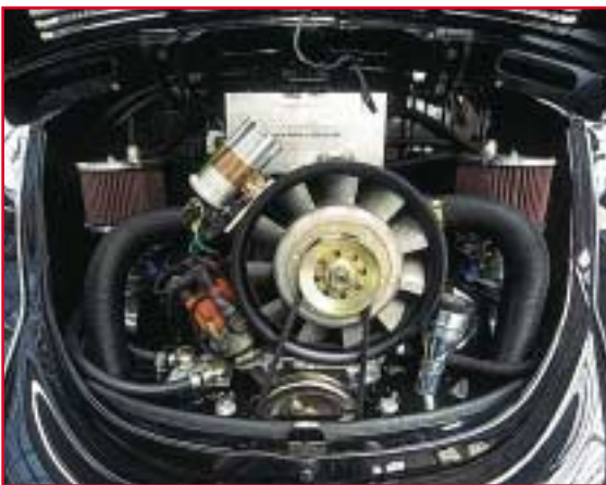
Satte Power dank TDE: Der 2-Liter-Typ 4 ist für etwa 150 PS gut
