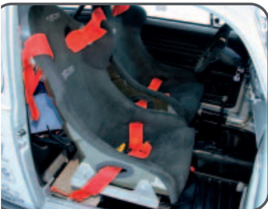
König fertigte für den Rallye-Käfer moderne Kevlar-Schalen mit Alcantarabezug an
