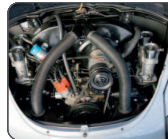
Drehzahl-Limit 7.000 U/min: Der 1600er geht wie die Hölle, man beachte den gekürzten Lüfterkasten mit den umgelenkten Heizungsschläuchen
